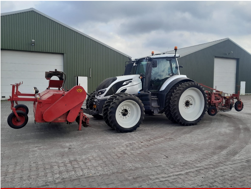
Gillis 2 fasen rooier inclusief lader (exclusief trekker)
